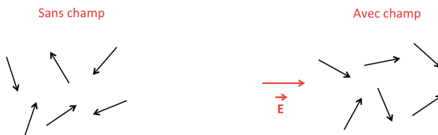
FIGURE 5.3 – La polarisation dipolaire résulte de l'orientation des molécules polaires dans un champ \vec{E} .
